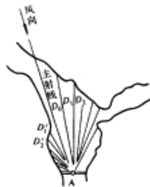
图 G1 等效风区长度计算示意图
