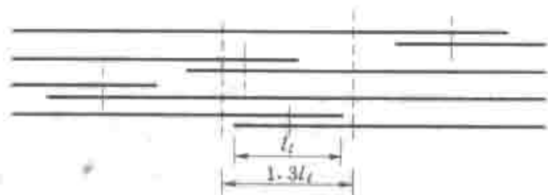
图 9.4.5 同一连接区段内的纵向受拉钢筋绑扎搭接接头
